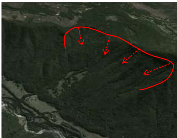
a) Imagen de deslizamiento histórico. (36° 54.512'S- 71° 34.350'O). En color rojo destaca el arco de despegue. Fecha de la imagen: 31-03-2001
