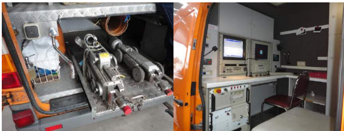
Figura 68. Equipo de inspección robótica. Fuente: Plan de mantenimiento preventivo de redes, Essbio S.A.
